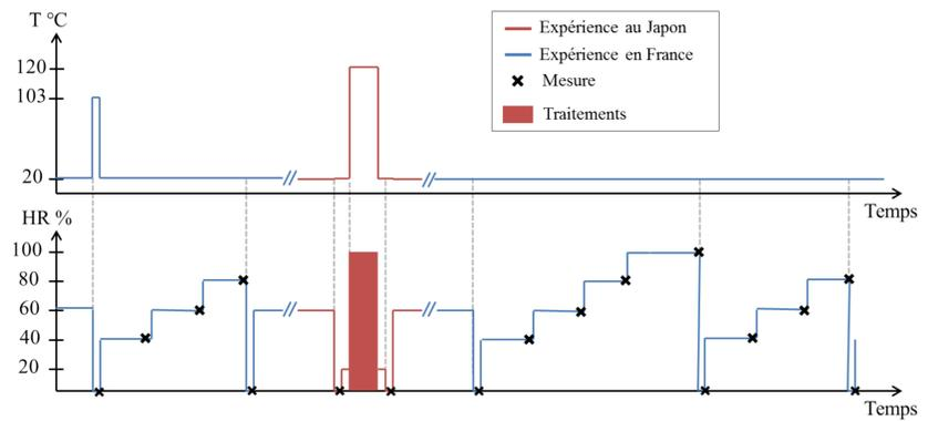
Traitement hygrothermique 24h, 120°C. Effet des conditions de traitement sur l'humidité interne d'équilibre (emc). Réversibilité des traitements hygrothermique pour les humidités de traitement en-dessous de 75% HR → Processus d'hornification
