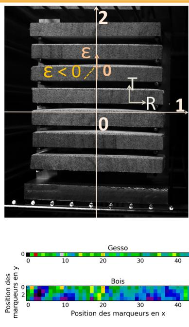
Analyse des déformations surfaciques (par CIN) et ses relations avec la courbure lors d'un séchage (de 55% à 34% HR) d'échantillons de bois recouverts d'une couche préparatoire
