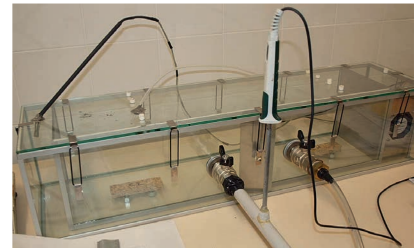
Figure 2. Méthodologie de la chambre d'émissions selon NF EN ISO 16000-9. © É. Masson.
