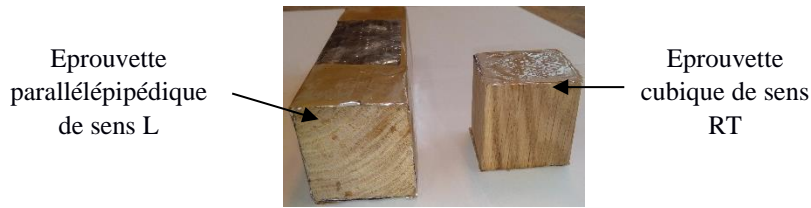
Figure 1 . Epreuves de dimension longitudinale (50 x 50 x 200 mm 3 ) et transversale (50 x 50 x 50 mm 3 )
