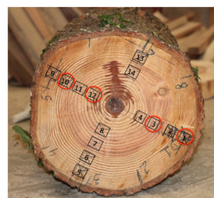
Fig. 3 : Douglas, Biron, Billon 1 - Indication et des prélèvements des barreaux (en rouge ceux étudiés par le laboratoire Navier)
