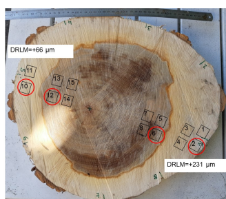
Fig. 2 : Peuplier, Biron, Billon 1 – Indication des mesures DRLM et des prélèvements des barreaux (en rouge ceux étudiés par le laboratoire Navier)
