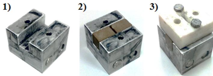
**Figure 3.** Étapes de fabrication des échantillons parallélépipédiques
