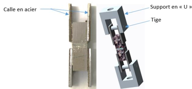
**Figure 5.** Dispositif expérimental pour l'essai de traction directe.
