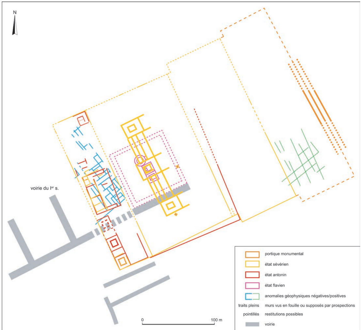
Fig. 28 – Plan d'ensemble des principaux états monumentaux du grand sanctuaire central du Vieil-Évreux (DAO : L. Guyard, MADE-Département de l'Eure).
