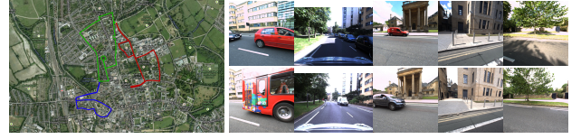
FIGURE 3 – Robotcar Dataset : La carte de gauche représente la division des parcours utilisés : en vert la zone d'apprentissage, en bleu la zone de validation et en rouge la zone de test. Les images à droite sont extraites des données de test, avec en haut l'image requête et en bas l'image la plus proche dans la base de test. On constate des changements importants entre les images requête et les images de la base qui sont dus à des occultations ou des changements de points de vue et d'illumination.
