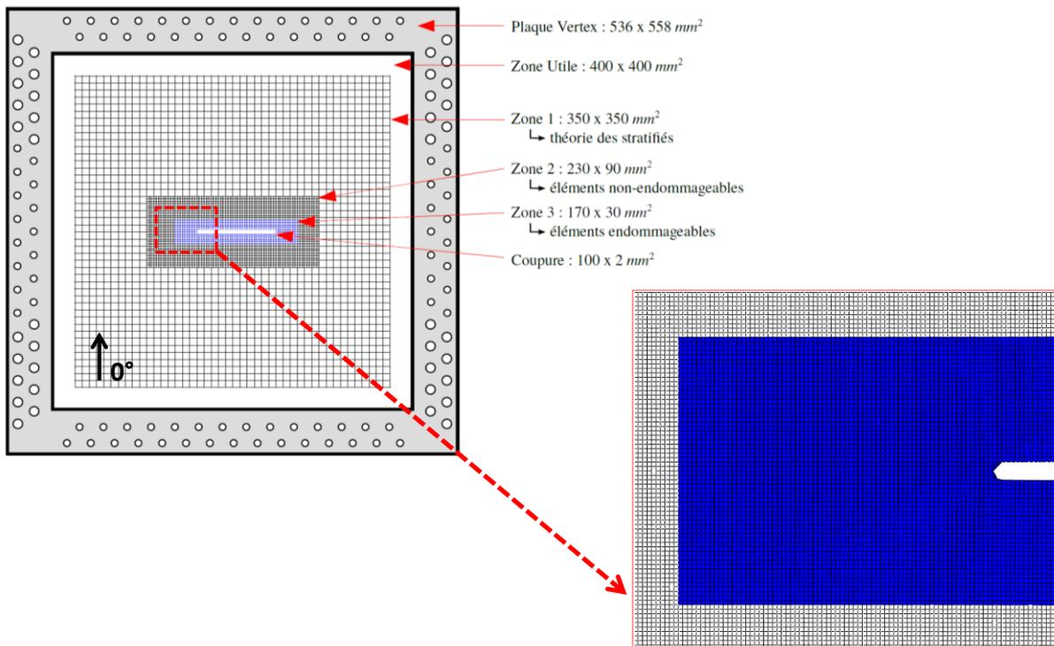
Figure 4 - Modèle numérique (3 zones) d'une éprouvette VERTEX
