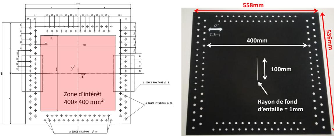
Les stratifiés composites étudiés sont élaborés à partir de plis unidirectionnels carbone/époxy (T700/M21) d'épaisseur 0.125mm. Ces derniers sont munis d'une entaille de longueur 100mm et de rayon de fond d'entaille 1mm. Les trois drapages considérés sont symétriques et équilibrés, ils contiennent 23% de plis à  $0^\circ$  :
