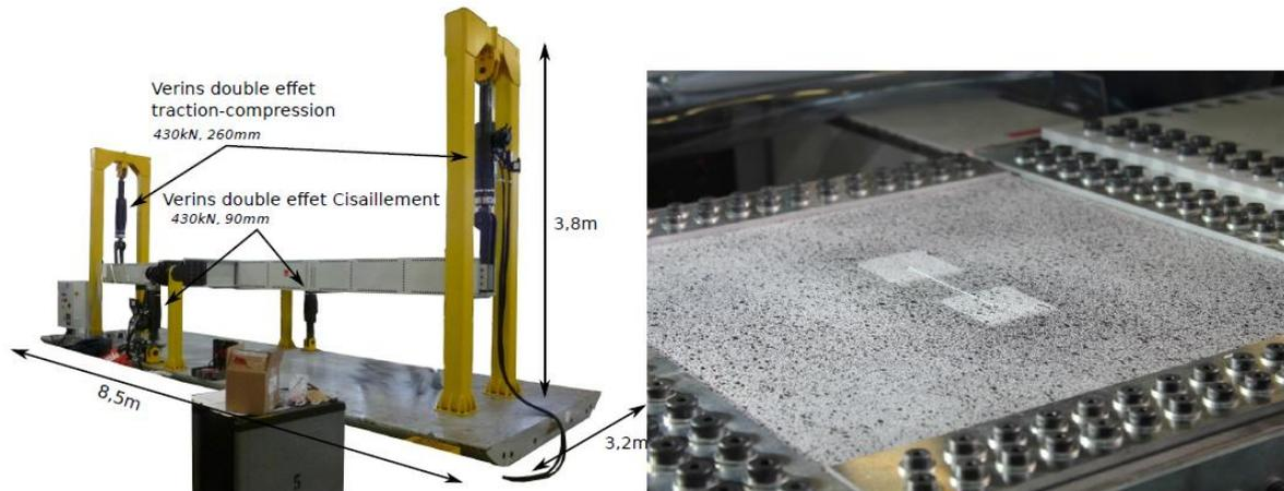
L'éprouvette de dimensions  $558 \times 536 \text{ mm}^2$  constitue la partie supérieure du caisson central et est fixée sur les cornières à l'aide de 128 vis (Figure 3).
