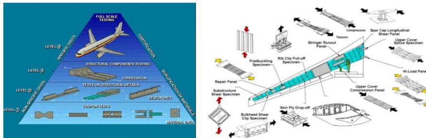
Figure 1 – (a) Pyramide des essais (source : Airbus); Essais de certification d'un caisson de voilure carbone (source : NASA)
