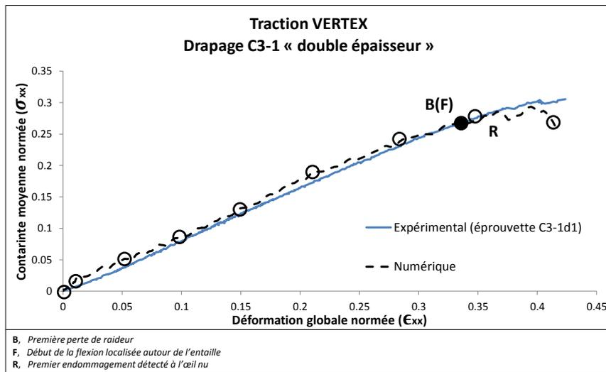
Figure 7 - Courbes Contrainte/Déformation de la plaque composite soumise à de la traction
