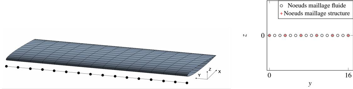
FIGURE 1 – i) Maillage 3D utilisé pour calculer le champ de pression et maillage 1D équivalent ii) Maillage fluide 1D et maillage structure 1D
