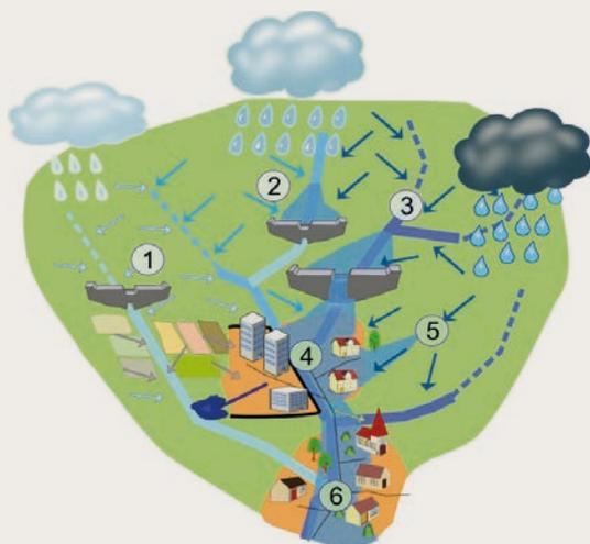
Les sous-bassins versant délimités par les ouvrages écrêteurs (1), (2) et (3) sont soumis à des pluies locales différentes ; or, c'est la combinaison de ces trois fonctionnements spécifiques qui va déterminer la crue en entrée de la ville (4).
