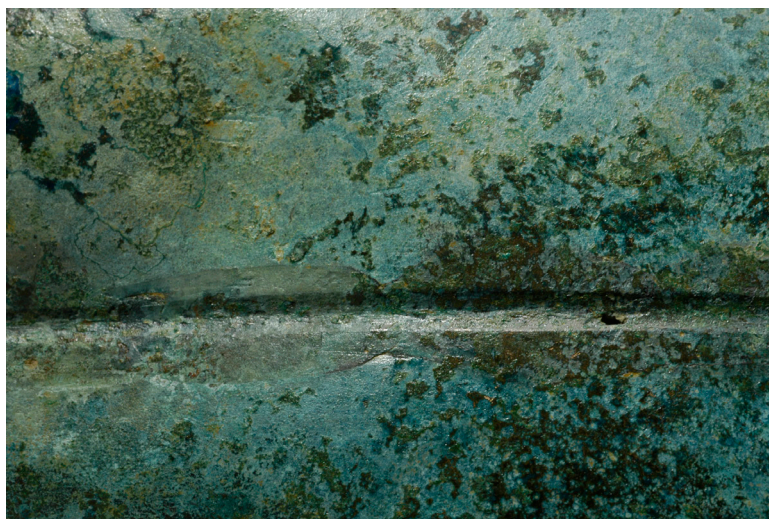
Fig. 59. Détail des taches grises, stigmates de la brasure (cl. B. Armbruster, CNRS).
