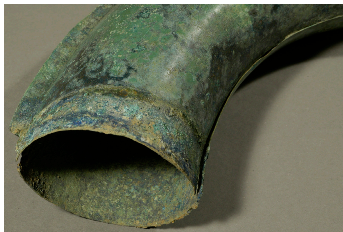
Fig. 38. Traces de brasures à l'étain (cl. B. Armbruster, CNRS).
