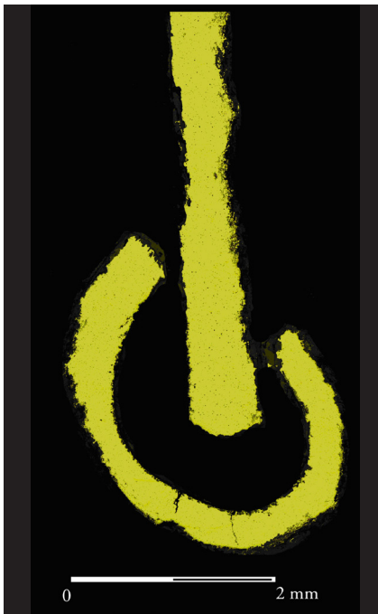
Fig. 63. Observation au microscope optique de la section polie perpendiculaire au bord du fragment prélevé visible sur la fig. 62. La pièce de tôle cintrée servant d'ourlet au bord du casque est clairement mise en évidence.
