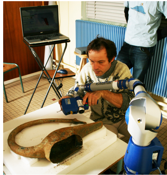
Fig. 77. Utilisation du scanner à balayage laser sur le casque-oiseau (ArchéoTransfert).
