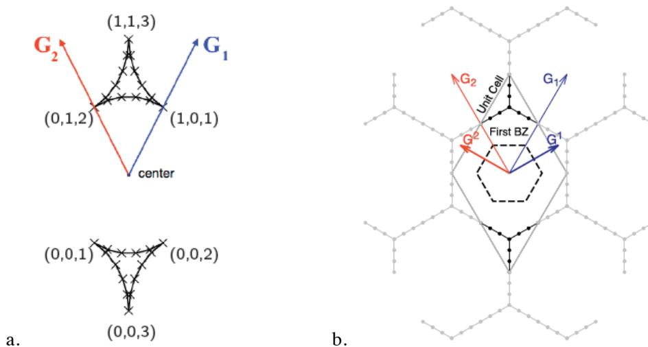
Figure 1 : a. Exemple de cellule primitive et de ses vecteurs de base  $(\mathbf{G}_1, \mathbf{G}_2)$  pour un nid d'abeille hexagonal à cellules circulaires, avec illustration de la notation pour les nœuds frontières ; b. Illustration de la base directe  $(\mathbf{G}_1, \mathbf{G}_2)$  et sa base réciproque associée  $(\mathbf{G}^1, \mathbf{G}^2)$
