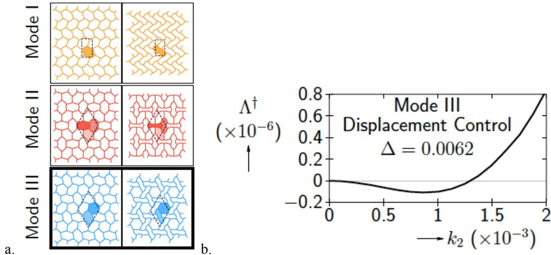
**Figure 3 : a. Modes de bifurcation pour un nid d'abeille en compression équi-biaxiale et b. zoom autour des longues longueur d'ondes pour le critère par ondes de Bloch pour une configuration d'équilibre juste après le point de bifurcation sur le chemin bifurqué du mode III sous sollicitation de déplacement contrôlé.**
