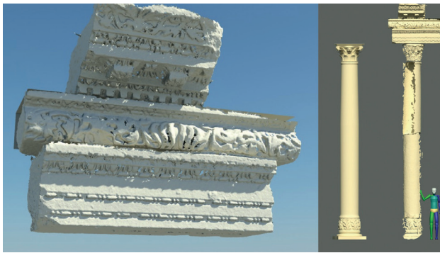
Fig. 5. Restitution de l'entablement et d'une colonne du premier niveau du théâtre. Photogrammétrie, P. Mora.
