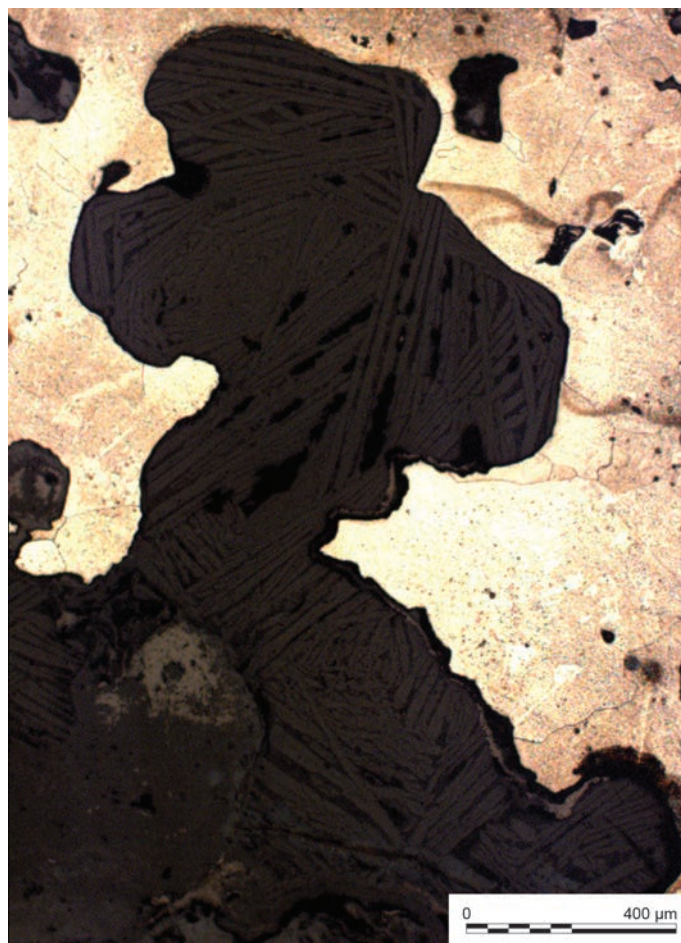
Fig. 10 – Micrographie de la face polie de 2000.001 : détail d'une inclusion fayalitique dans le métal (cliché : F. Sarreste, CAPRA/Éveha).
