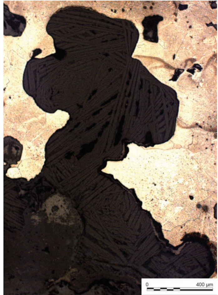
Fig. 10 – Micrographie de la face polie de 2000.001 : détail d'une inclusion fayalitique dans le métal (cliché : F. Sarreste, CAPRA/Éveha).
