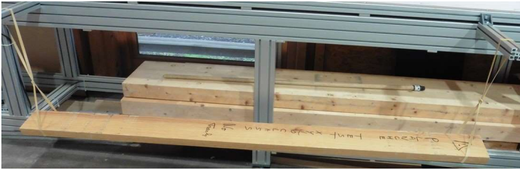
Figure 2 a: Mesures vibratoires en flexion
