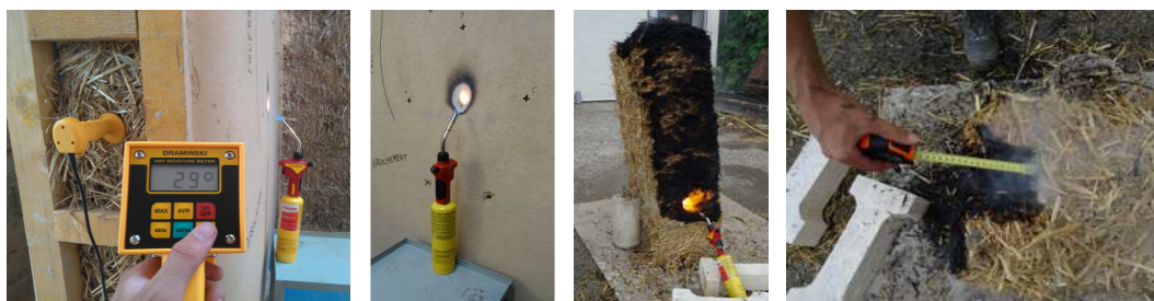
Figure 7. Essai de tenue au feu de l'enduit et d'une botte de paille nue exposés à une flamme de chalumeau.
