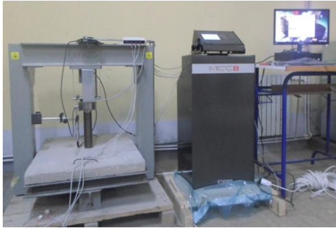
Figure 1. Machine d'essai, schématisation des appuis et positionnement du capteur de déplacement
