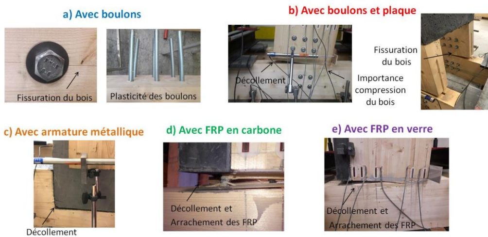
Figure 5. types de rupture de chaque connexion.
