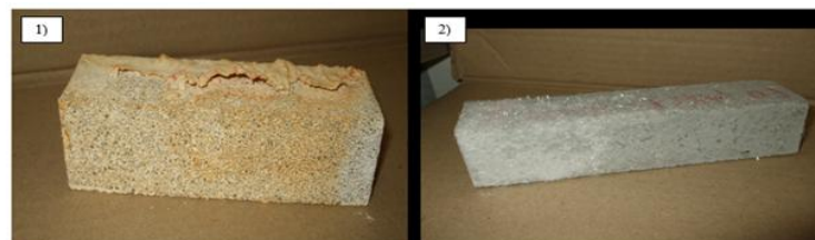
Figure 1. Éprouvettes conservées dans : 1) acide sulfurique, 2) sulfate d'ammonium.
