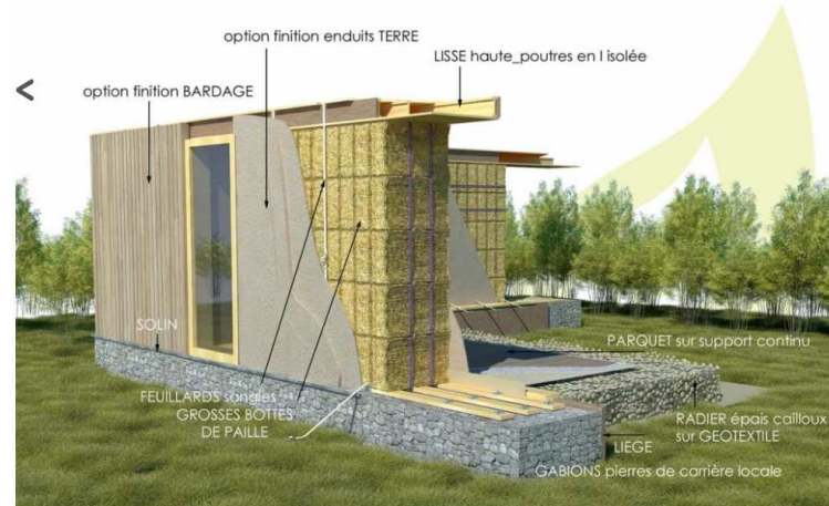
Figure 1. Principe de mise en œuvre d'un mur en paille porteuse (source : Projet adream - Architecteure Boha 2010).
