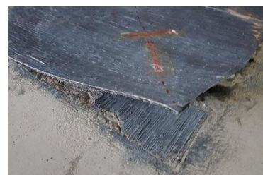
Figure 6. A) Décollement de Tissu en Fibre de Carbone. B) Décollement du composite des dalles pré-chargées
