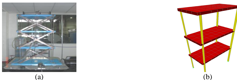
Figure 1. Le portique en acier monté sur la table vibrante (a) et son modèle en éléments finis (b).
