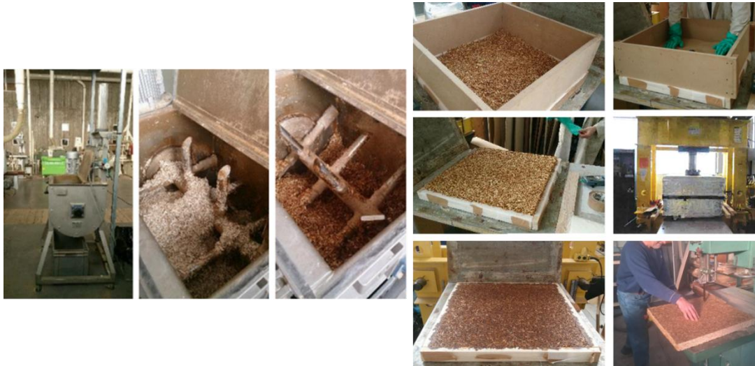
Figure 1. Illustration des étapes de fabrication du panneau rigide de chènevotte à l'aide d'un thermo-presse de laboratoire.
