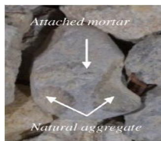
Figure.1. Compositions des granulats recyclés de béton
