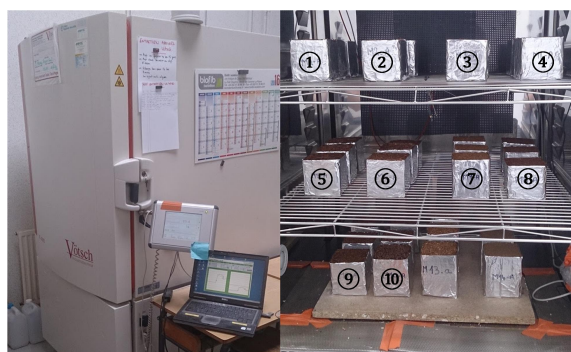
Figure 7. Dispositif expérimental pour la mesure de la valeur tampon hygrique
