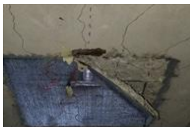
Figure 6. A) Décollement de Tissu en Fibre de Carbone. B) Décollement du composite des dalles pré-chargées
