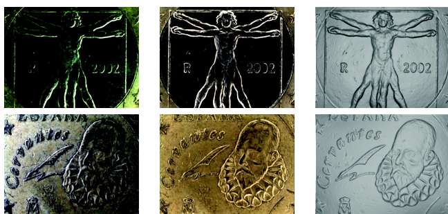
FIGURE 4 – Première ligne : pièce de 1 euro italienne. Deuxième ligne : pièce de 50 centimes espagnole. De gauche à droite : une des m = 15 images, albédo estimé et relief estimé.
