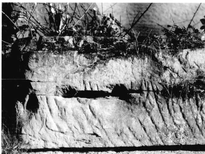
Fig. 128 – Emboitures préparant l'extraction restée inachevée d'une couche de roche de faible épaisseur (35 cm environ) dans la partie centrale de la carrière du Kriemhildenstuhl, Bad Dürkheim (photo P. Adam).
