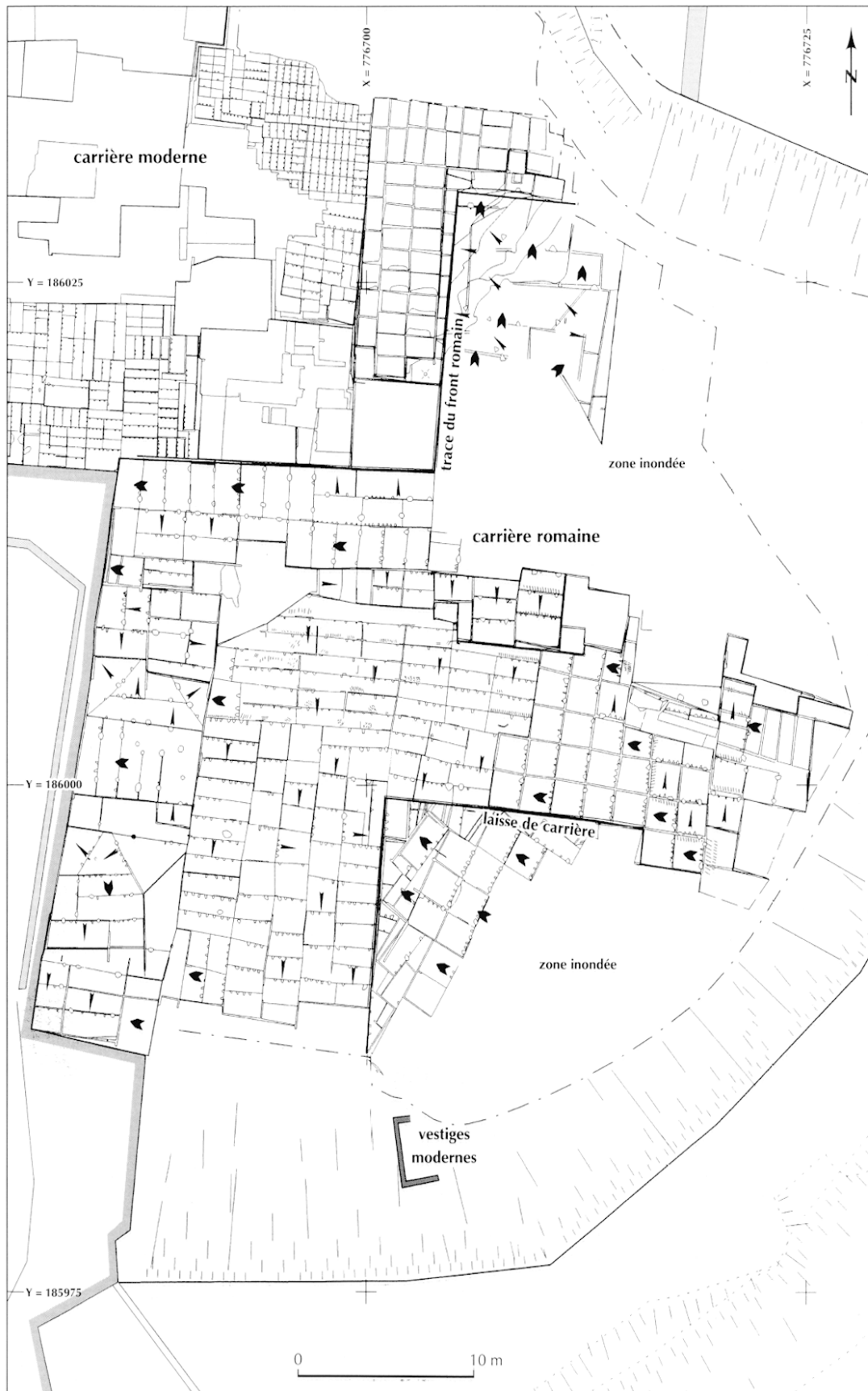
Fig. 7 – Plan partiel simplifié de la carrière montrant les canevas d'extraction antiques et modernes ainsi que le sens de la progression générale, d'est en ouest, de l'exploitation romaine (flèches en gras dans les secteurs n os 1, 4, 5 et 13 ; les autres directions, à caractère secondaire (petites flèches), sont imposées par des contraintes géologiques et surtout par la laisse de carrière (proposition de J.-C. Bessac à partir des relevés de C. Pradiès ; relevés topographiques O. Sennoune et V. Vachon, INRAP ; fond de plan, cabinet Houssard, Nîmes et V. Vachon, INRAP ; mise au net V. Vachon et A. Recollin, INRAP).
