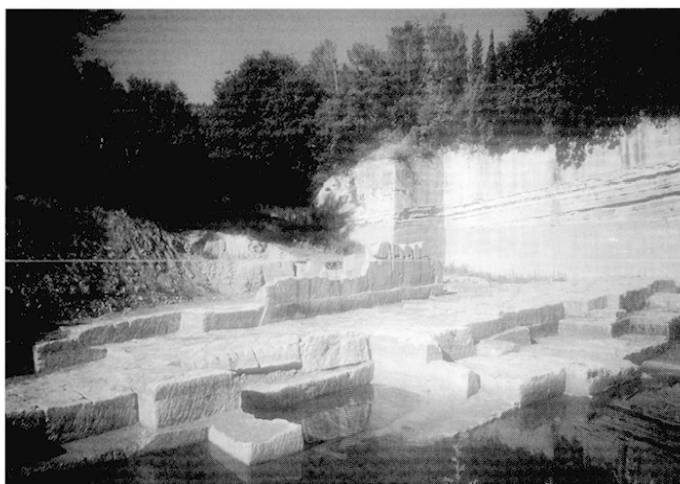
Fig. 14 – Sol de carrière du chantier romain sous l'eau ; en bas, au milieu, se trouve un grand bloc calé en position de chargement pour être embarqué probablement sur un radeau, il a été abandonné à la suite d'une cassure ; au centre, on aperçoit la grande laisse de carrière sud-ouest ; au-dessus, à l'arrière-plan, le front de carrière présente une avancée propice à l'installation d'un engin de levage (photo J.-C. Bessac, CNRS).
