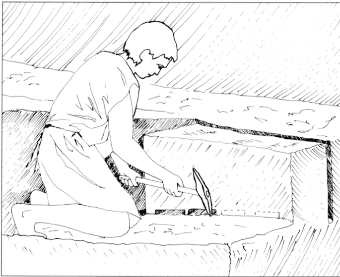
Fig. 22 – Creusement d'emboîtures romaines à l'aide d'un mortaisoir (dessin M.-R. Sire).
