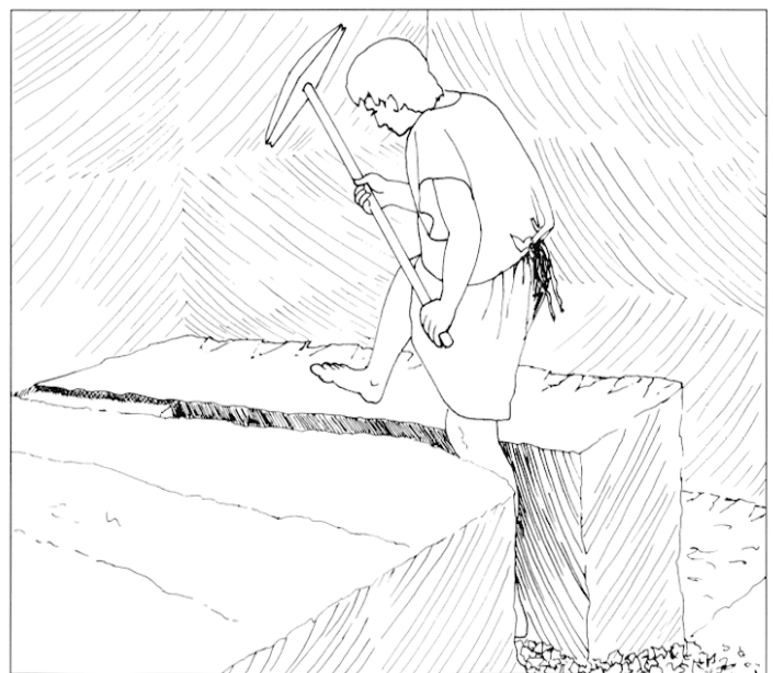
Fig. 20 – Position de travail d'un carrier romain au cours du creusement d'une tranchée d'extraction à l'aide d'une escoude à doubles dents pointues (dessin M.-R. Sire).
