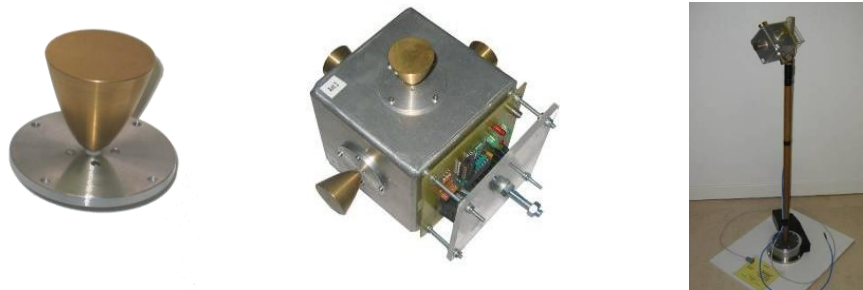
Figure 10 : Réseau virtuel circulaire d'antenne multi-axes UWB a) Capteur ULB b) Réseau ULB c) Réseau virtuel circulaire
