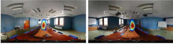
Figure 10. Répartition spatiale de l'énergie ( \tau=5,2ns )
