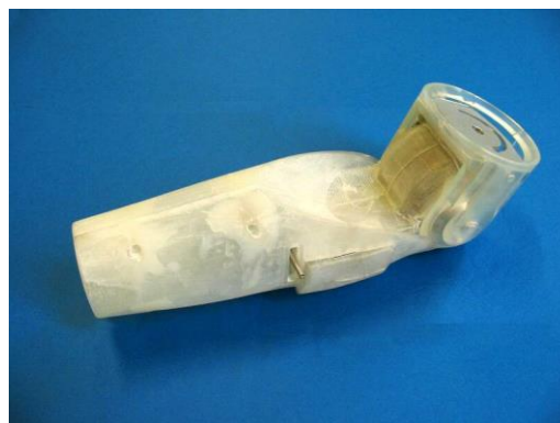
Figure 7 : photo du coude myoélectrique seul
