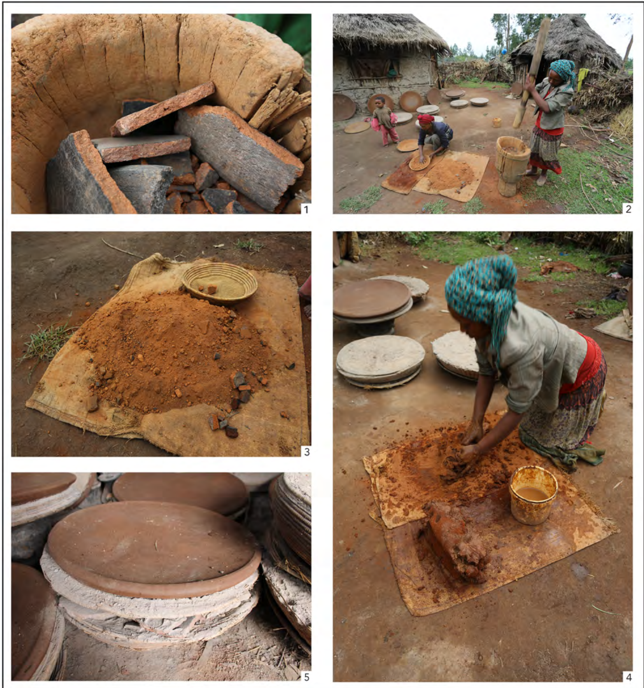
Fig. 13 – Oromo social group at Qarsa. 1: broken Ingera sherds used to make grog; 2: sherds are broken up using a wooden pestle; 3: the relatively fine fraction of grog, after sieving; 4: subsequent addition of the grog to the red clay; 5: ingera dish after shaping. Fig. 13 – Les Oromo de Qarsa. 1 : fragments de plats à Ingera utilisés pour fabriquer de la chamotte ; 2 : les potières les brisent dans un mortier au pilon ; 3 : la chamotte obtenue après tamisage est relativement fine ; 4 : les potières incorporent la chamotte à l'argile rouge ; 5 : le plat à Ingera après l'ébauchage et le préformage.
