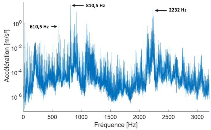
Figure 15 : Mesure vibratoire en charge (glissement à 5.3%).
