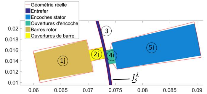
Figure 8 : Comparaison entre la géométrie réelle et le modèle de sous-domaines à géométrie polaire.
