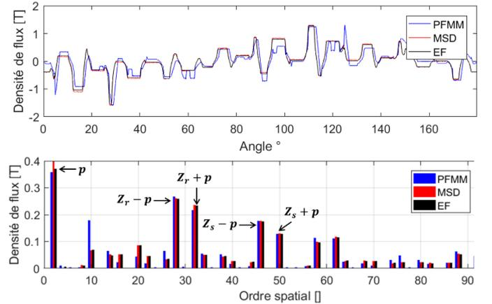
Figure 13 : Induction radiale et FFT en fonction de l'angle dans l'entrefer à  $t = 0$ .
