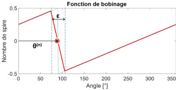
Figure 4 : Fonction de bobinage élémentaire d'un conducteur.
