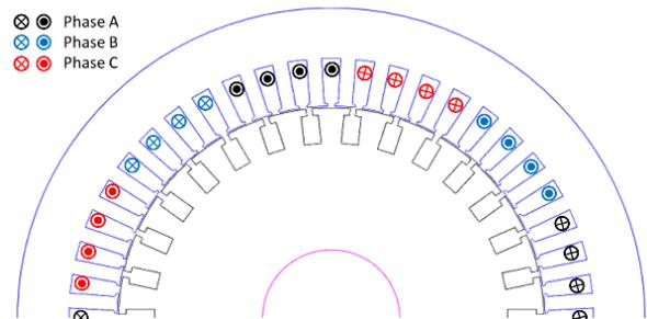
Figure 1 : Vue de la machine étudiée (48 dents / 30 barres).
