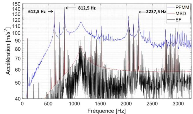
Figure 16 : Comparaison du spectre vibratoire obtenu en charge (glissement à 5%) pour chacun des modèles.
