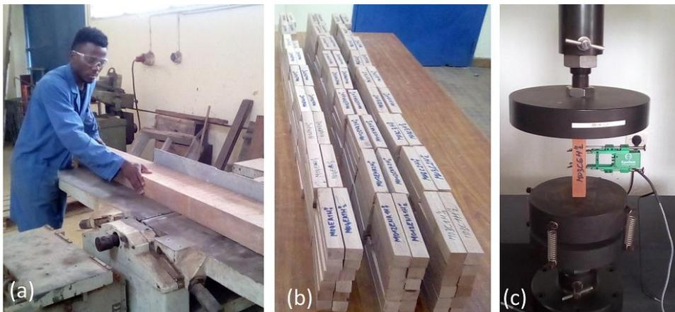
Fig. 2. (a) Dégauchissage de la poutre. (b) Echantillons pour la caractérisation et la variabilité spatiale. (c) Dispositif expérimental d'essai de compression.
