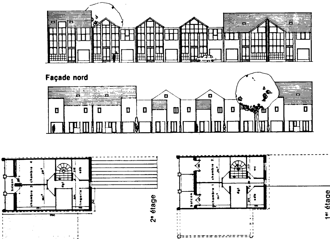
Fig. 9: Exemple de plan "bioclimatique" sur un seul niveau : séjour au Sud, logement traversant : Maison "CAPELIO", Architecte: Groupe ERSOL (lauréat concours "5000 Maisons solaires").
