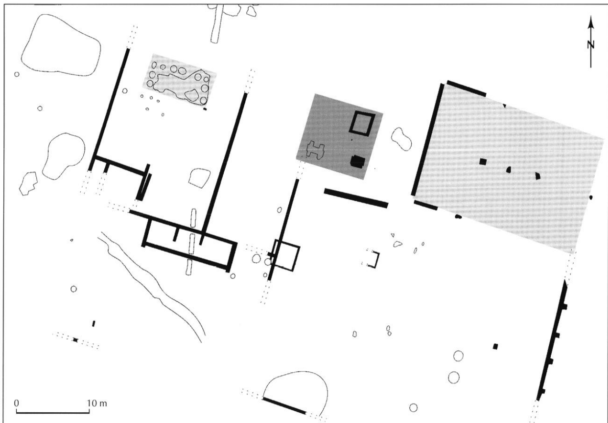
Fig. 47 – La villa du Petit Clos à Perpignan, Hérault : en grisé clair, les différents espaces de stockage ; en grisé sombre, les pressoirs (dessin P. Garczynski, CEPAM-CNRS d'après J. Kotarba, complété).
