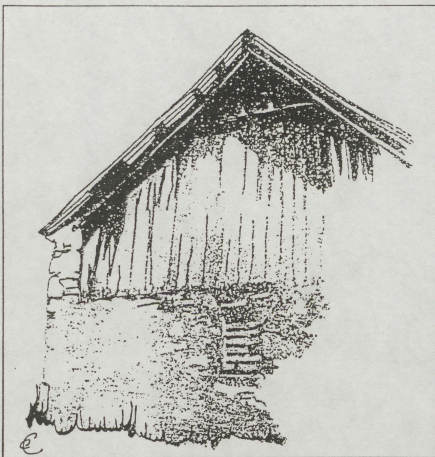
LA " MIDIERA " Fermeture du pignon en bardage bois
