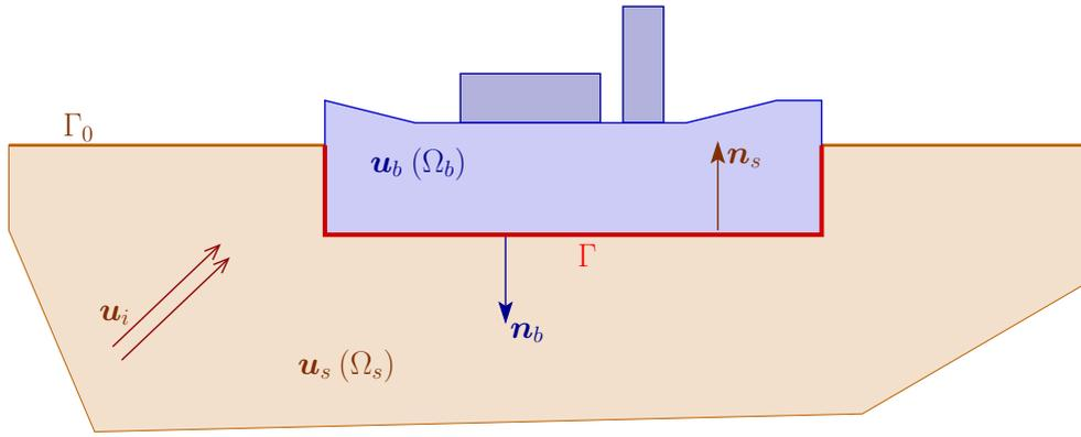
FIGURE 2 – Schématisation d'une méthode de sous-structuration.
