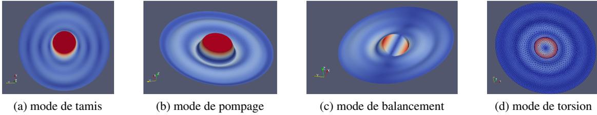
FIGURE 4 – Modes de corps rigide d'une fondation.
