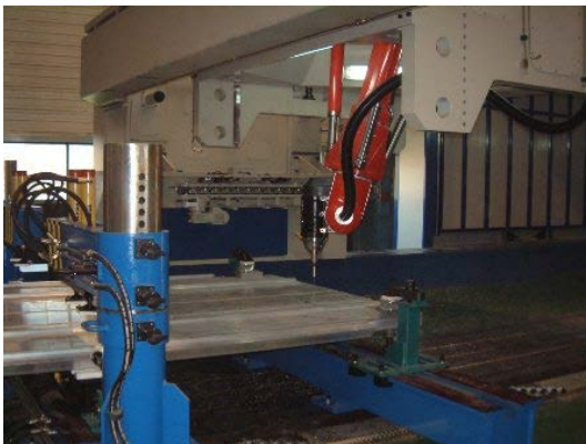
Figura 12 Robot Tricept utilizado en el mecanizado de rieles de tren y como centro de mecanizado comercializado por la empresa LOXIN [38].
