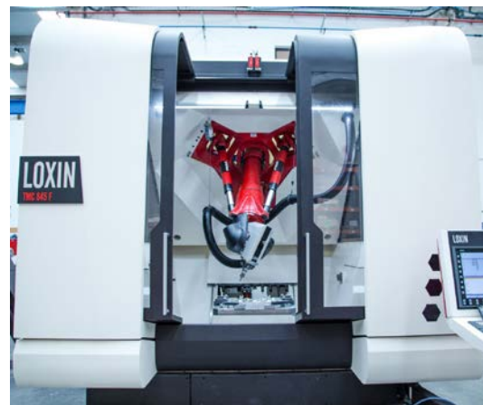
Figura 12 Robot Tricept utilizado en el mecanizado de rieles de tren y como centro de mecanizado comercializado por la empresa LOXIN [38].
