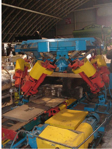
Figura 3 Máquina para ensayo de neumáticos, Robot paralelo de 6 GdL propuesto por Gough [7].
