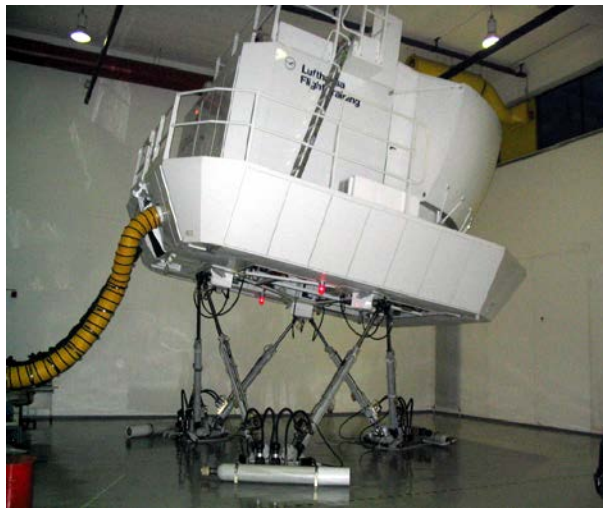
Figura 4 Plataforma Stewart usada por Lufthansa como simulador de vuelo [10].
