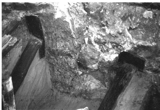
**Fig. 62** – *La Fagassière (Château-Chervix, Haute-Vienne) : étauage simple avec des planchettes utilisées pour caler des étais transversaux.*
