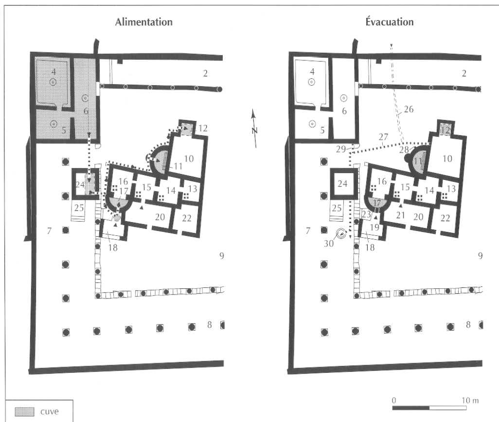
Fig. 7 – Aléria, le « Prétoire » : système d'alimentation et d'évacuation des thermes (plans de l'auteur d'après fonds Leandri, Thernot, 1994).
