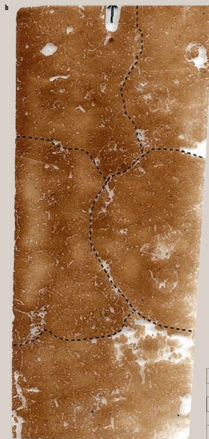
b. Emboîtement de mottes quadrangulaires ou subarrondies, malaxées (mélange de limons et d'argiles issus d'horizons lessivés et de Bt).
