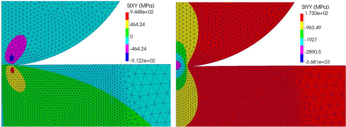
FIGURE 1 – Résultats numériques obtenus avec la condition LAC en 2D avec un maillage triangulaire à 6 nœuds pour  $t = 0.5$  : Contrainte  $\sigma_{xy}$  (gauche) et contrainte  $\sigma_{yy}$  (droite) sur la configuration déformée.
