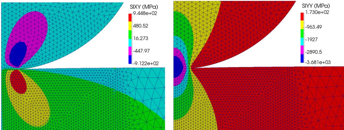
FIGURE 2 – Résultats numériques obtenus avec la condition LAC en 2D avec un maillage triangulaire à 6 nœuds pour  $t = 1.0$  : Contrainte  $\sigma_{xy}$  (gauche) et contrainte  $\sigma_{yy}$  (droite) sur la configuration déformée.
