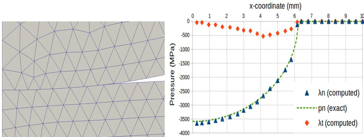
FIGURE 3 – Résultats numériques obtenus avec la condition LAC en 2D avec un maillage triangulaire à 6 nœuds pour  $t = 1.0$  : Interface de contact entre les deux solides sur la configuration déformée (gauche). Multiplicateurs de Lagrange normal et tangential, pression de contact exacte (droite).
