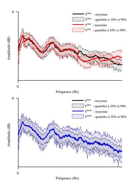
FIGURE 1 – Comparaison des moyennes et des quantiles des processus  $Y_k^{\text{mes}}(\omega)$  avec  $Y_k^{\text{sim}}(\omega, \mathbf{w}_0)$  (figure du haut), et  $Y_k^{\text{mes}}(\omega)$  avec  $Y_k^{\text{mod}}(\omega, \mathbf{w}_0)$  (figure du bas), pour la composante k qui correspond à une accélération verticale de caisse
