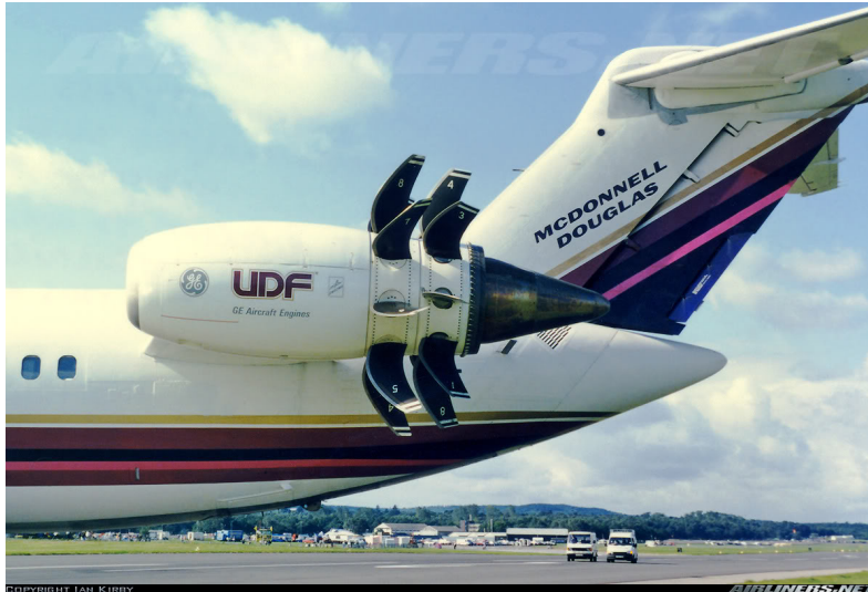
FIGURE 1 – Motorisation CROR montée sur un McDonnell Douglas MD-81.
