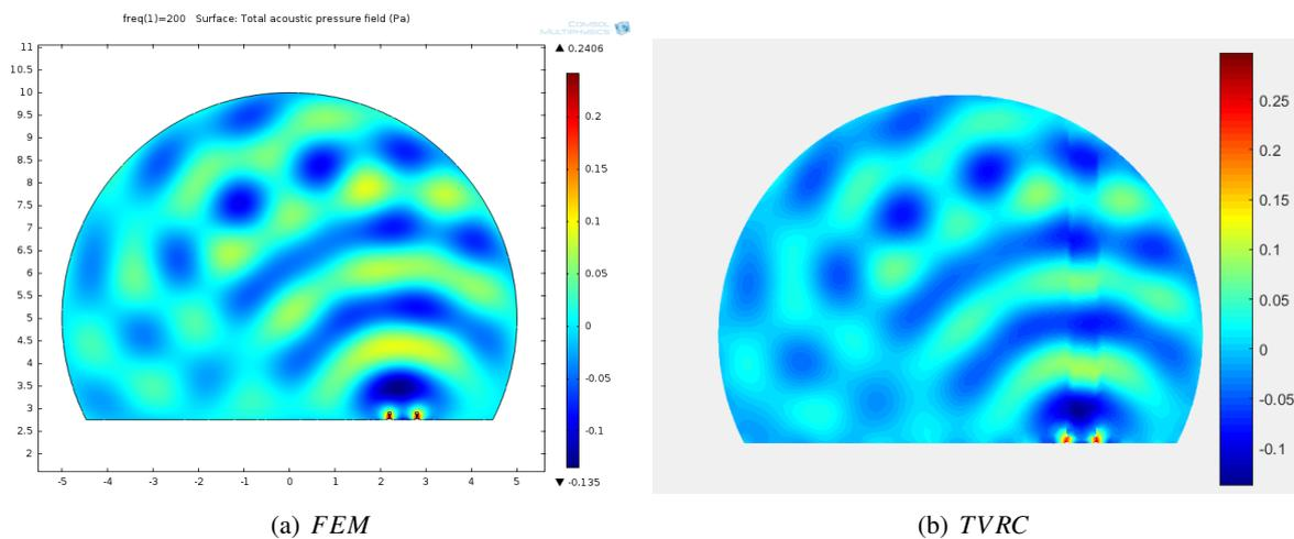
FIGURE 7 – Rayonnement du rail dans un tunnel à 200 HZ
