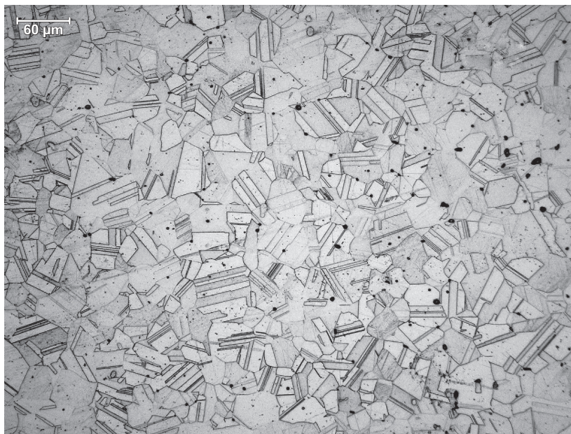
Fig. 11 – Microstructure en grains polygonaux observée sur un plan de coupe du flan 1389-1. Ceci correspond à une recristallisation du bronze après déformation plastique et recuit (micrographie : F. Adamski, CNRS-IRAMAT).
