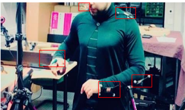
Figure 8: Placement des billes infrarouges
