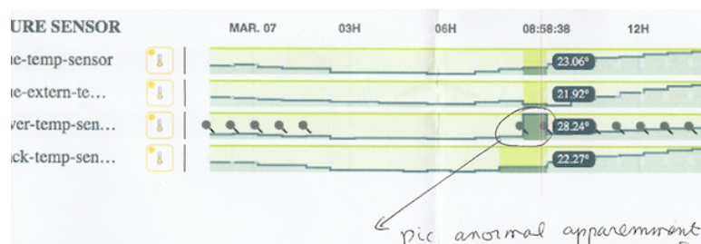
Figure 11. Pic anormal sur la ligne de vie du capteur de température du salon : il avait été oublié sur la table ensoleillée de la terrasse.
