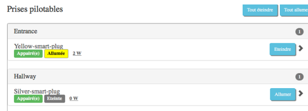
Figure 8. Extrait du panneau de contrôle des prises pilotables montrant leur état, la consommation électrique instantanée et les actions que l'utilisateur peut leur appliquer.
