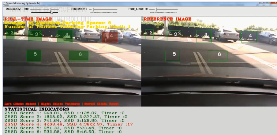
FIG. 1 – Prototype de l’application développée pour la gestion et la surveillance en temps réel des places de parking.
