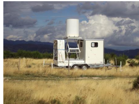
Figure I-4 : (Haut) Radar bande X avec son radome sur le toit de l'OPGC. (crédit : Cyril Frésillon, photothèque CNRS); (Bas) Radar bande X mobile (crédit J. Van Baelen, LaMP)
