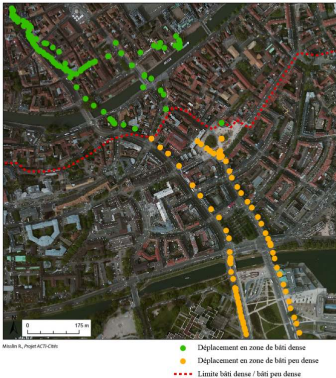
Figure 7 : Exemple de modification de la précision des relevés GPS en fonction de la morphologie urbaine.
