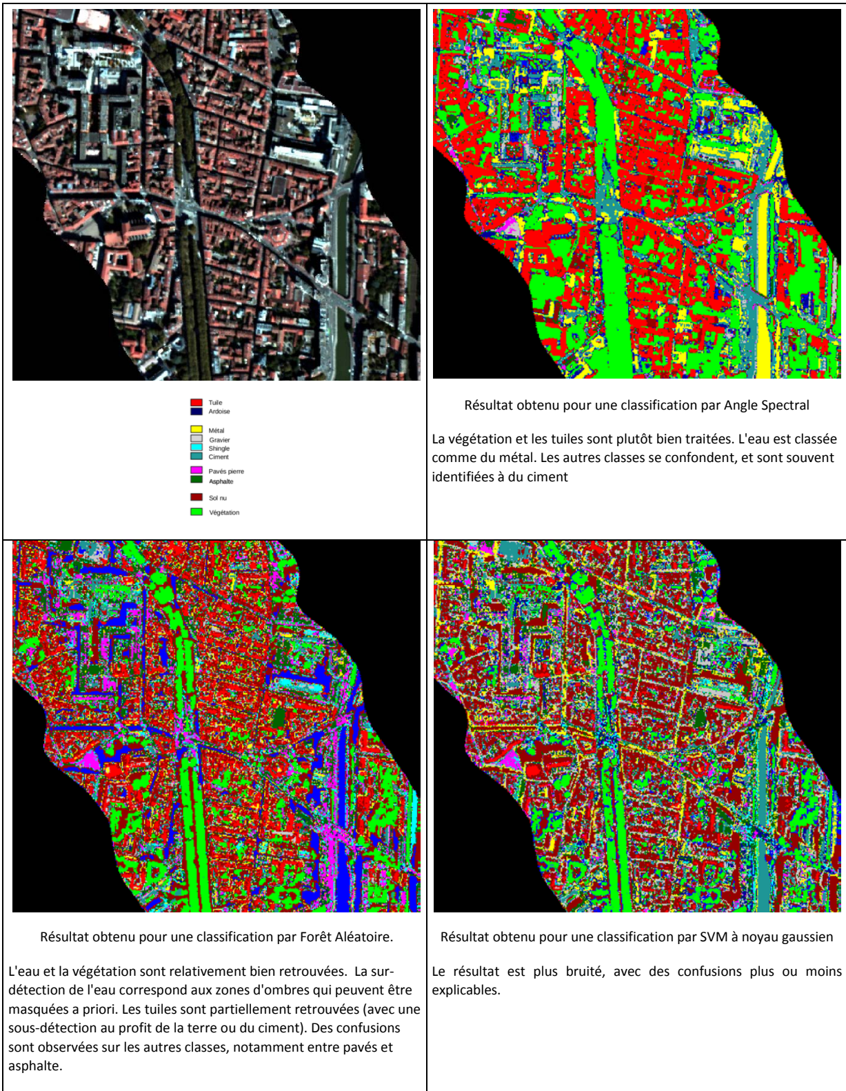
Figure 2 - Résultats obtenus par différents classifieurs pour un apprentissage à partir de la base de données spectrale.
