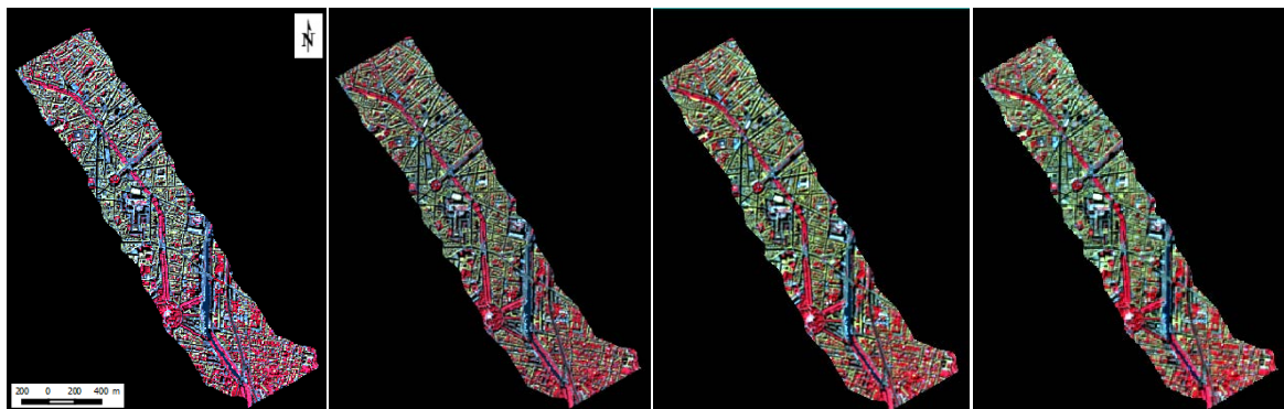
Figure 34 – De gauche à droite : composition colorée de l'image Hypex (résolution spatiale 2 m), de l'image synthétisant HYPXIM à 4m, de l'image synthétisant HYPXIM à 8m, et de l'image synthétisant sentinel-2 à 10m.
