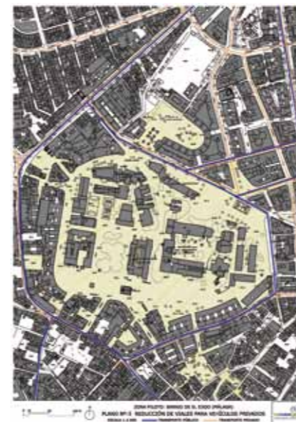
Plano que refleja el aumento de la superficie peatonal total del Campus de El Ejido (resaltada en amarillo), en consecuencia de la limitación de la circulación de los vehículos privados a las solas calles perimetrales del área piloto (marcadas en azul)
